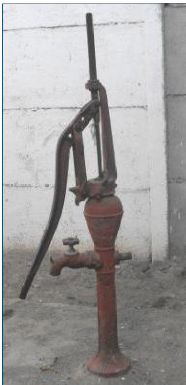
Bomba para extracción de agua, Los Choros.
