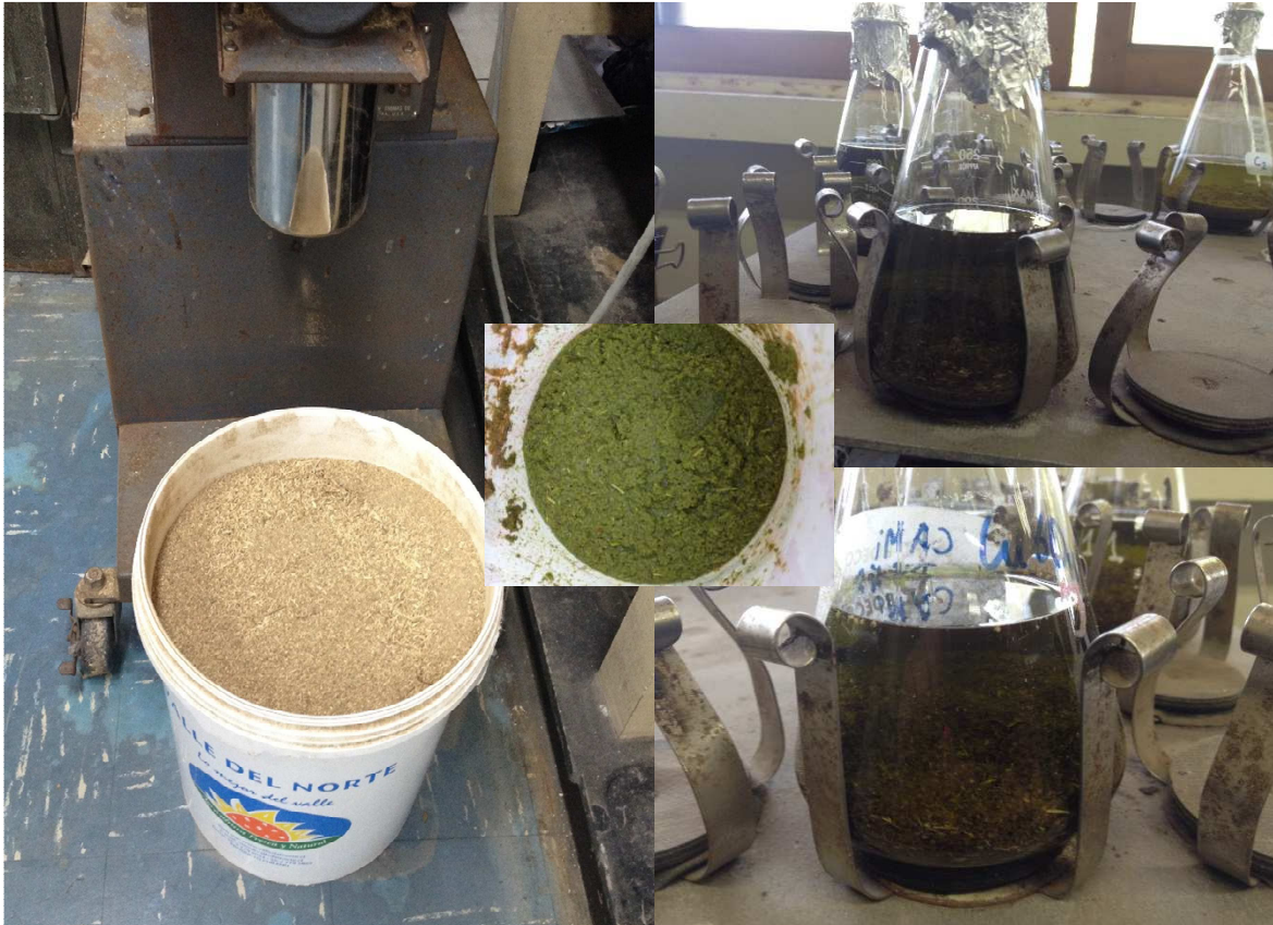
Fotografía N° 8: Extracción de Aceite de Salicornia.
